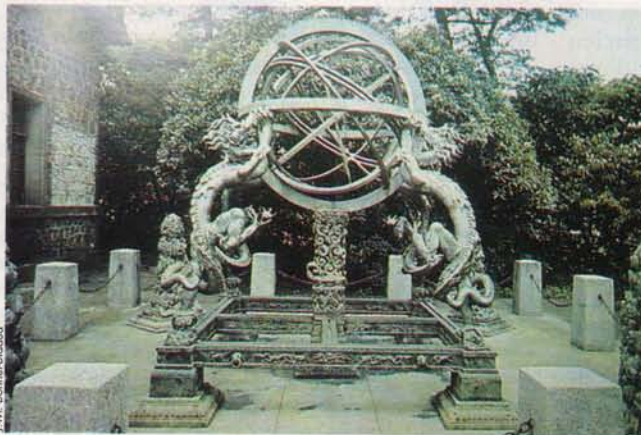
Aucun des instruments originaux utilisés par les Chinois avant le XIII e siècle n’a jusqu’ici été retrouvé. Le plus ancien existant est cette sphère armillaire, faite de cercles concentriques articulés, conservée à Nankin et attribuée à Guo Shoujing, créateur de l’observatoire de Pékin (1276).
