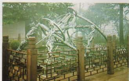
Version simplifiée de la sphère armillaire, le torquetum de l'observatoire de Nankin est un instrument équatorial, fidèle en cela à la tradition chinoise de repérer le ciel par rapport à l'équateur céleste, comme les astronomes modernes, et non par rapport à l'écliptique.
