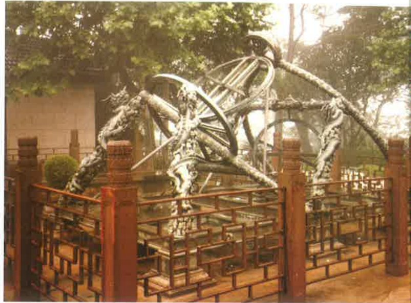
L'instrument à monture équatoriale inventée en Chine en 1279. Cette monture est similaire à celle de nombreux grands télescopes modernes. Cette copie datée de 1437 est conservée à l'observatoire de Nankin. © J.-M. Bonnet-Bidaud
