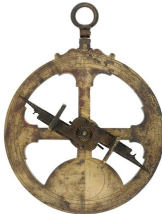
Astrolabe de marine (1588): astrolabe de marine ou astrolabe de mer typiquement utilisé à bord des navires. Le disque en laiton, qui doit être utilisé strictement verticalement, est évidé pour réduire la pression du vent en mer. Une règle pivotante ou alidade, équipée de deux viseurs, est utilisée pour mesurer les élévations des étoiles. Ce spécimen a été retrouvé en 1845 au large de l'Irlande, dans les épaves de navires espagnols de la Grande Armada, coulés en 1588.
